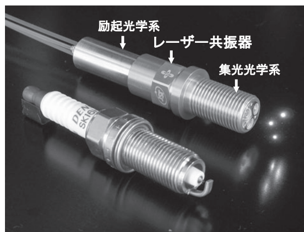
図7 マイクロチップレーザー (提供：分子科学研究所 平等准教授)
